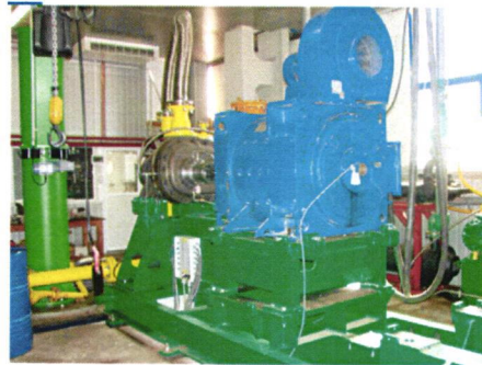
Stand de testare compresoare dezvoltate de INCD Turbomotoare COMOTI
